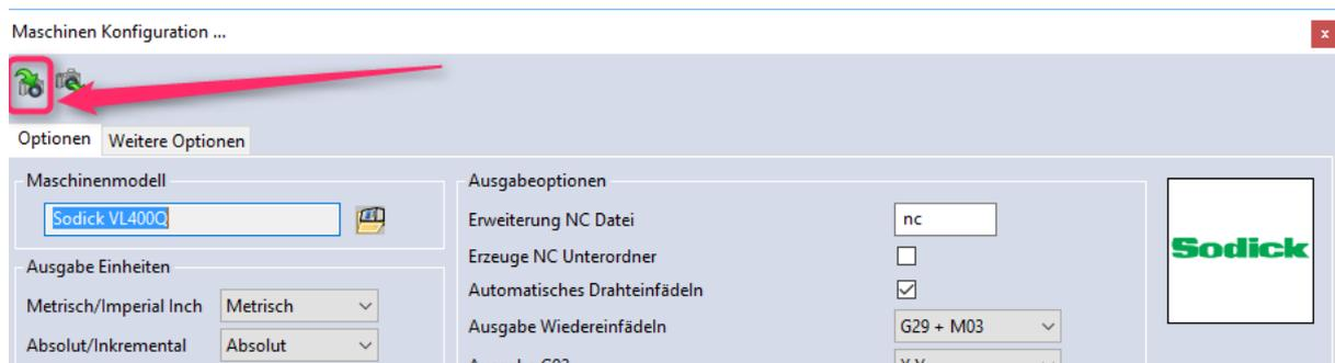
Starten Sie nun VISI2020.0, erzeugen und öffnen ein neues PEW Projekt mit der benötigten Maschine. Verwenden Sie das gekennzeichnete Icon, alle gesetzten Optionen und Einträge werden aus der gespeicherten \*.SNP Datei in die Maske der Maschinenkonfiguration in VISI2020.0 übernommen.
